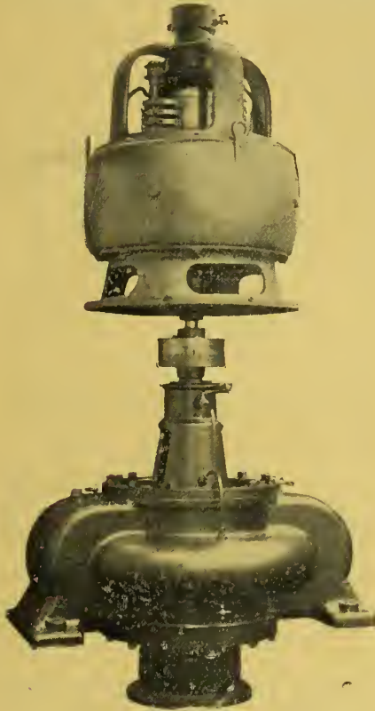
Brunnen-Abieuspumpe. Leistung 500 cbm p. Stunde.
