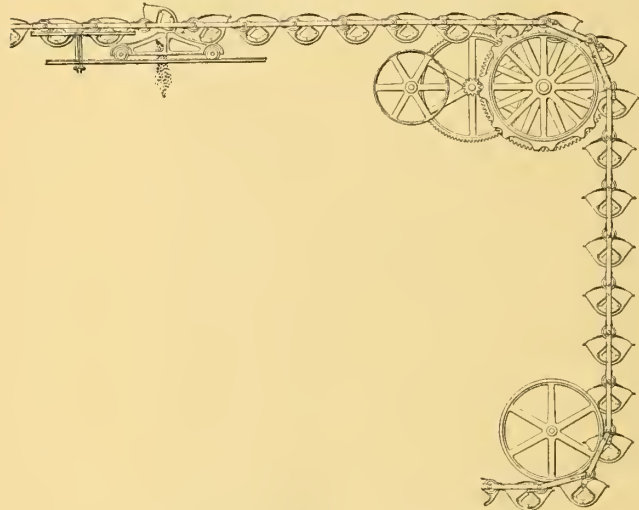
Fig. 9. Link-Belt-Becherkette für Kesselhäuser.
