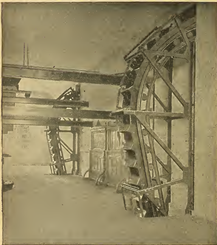
Fig. 3. Fig. 4. Fig. 3-4. Bradley-Becherkabel in der Gasanstalt Königsberg, gebaut von der Berlin-Anhaltischen Maschinenbau-A.-G.
