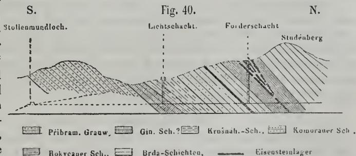
Er ist vom Mundlochean bis nahe zum 10 Klafter tiefen Lichtschachte in der Länge von 83 Klafter in Steinmauerung gesetzt, und unterteuft die Tagbaue um ungefähr 20 Klafter. Erst von der 83. Klafter an ist der Stollen offen, und kann die Reihenfolge der Gesteinsschichten erhoben werden. — Unmittelbar neben dem Lichtschachte stehen grüngraue und blaugraue Thonschiefer mit
