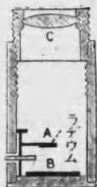
第60圖 スピンスコープ Aにラヂウムの化合物をおき、それより出る放射線がBなるZnSにぶつかつて螢光を出すから、Cなるレンズを通して見る。
