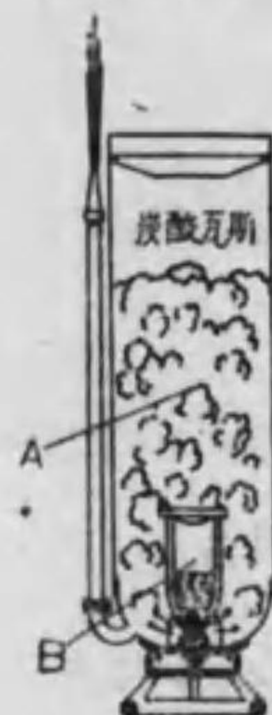
第71圖 消火器の原理 Aなる重曹水とB壺中の濃硫酸と作用して炭酸ガスを生じ、その壓力で重曹水が噴出してゐる光景。
