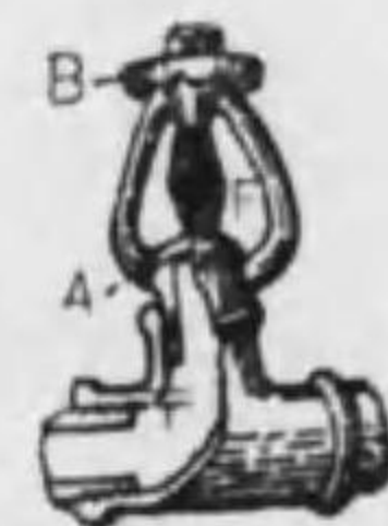
第 66 圖 スプリングラー 自働防火栓 圖のAは瓣であつて、 Fなる易鎔合金が鎔け るとA瓣は開きTなる 管から水が噴出する。
