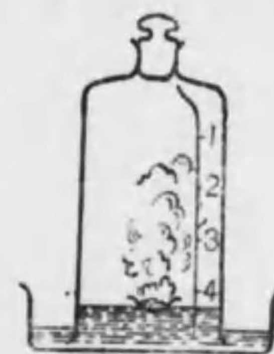
第5圖 空氣の \frac{1}{5} の容積が酸素で \frac{4}{5} の容積が窒素なることを知る實驗
