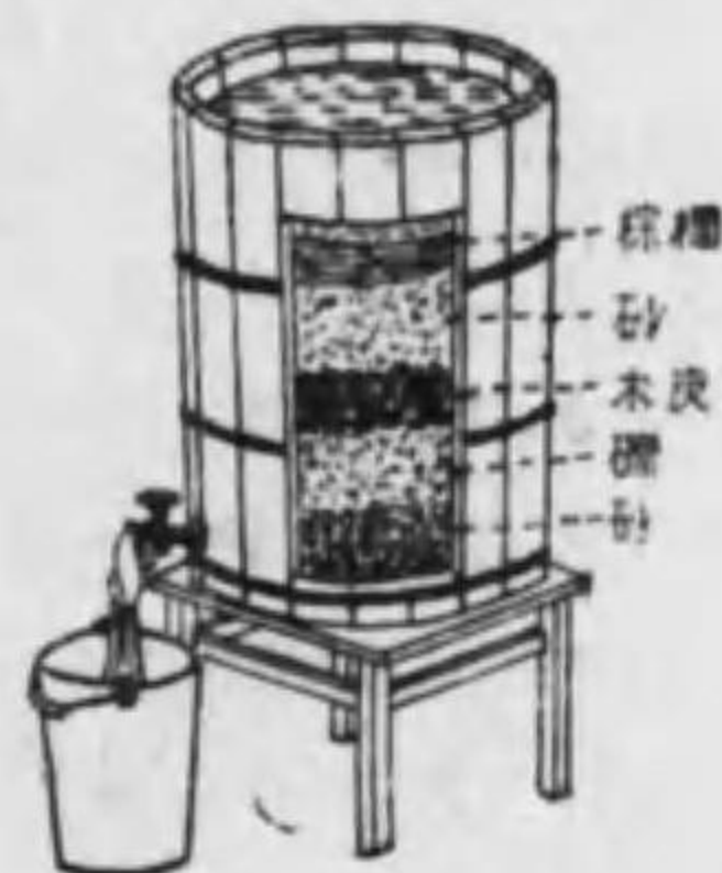
第11圖 水の濾過装置
