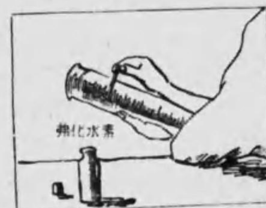
第40圖 弗化水素を用ひて硝子圓筒に目盛りをする
