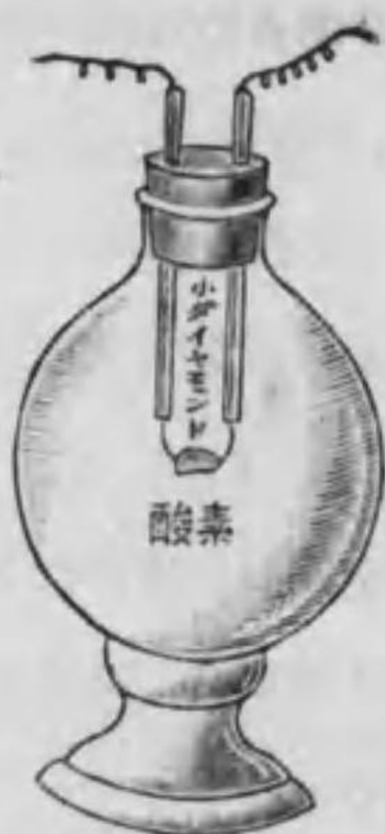
第21圖 ダイヤモンドを燃す實驗
