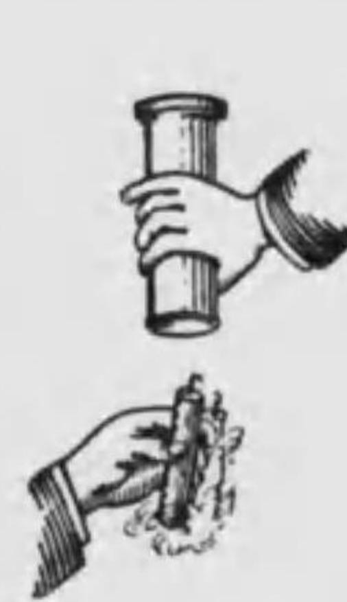
第26圖 炭酸ガスの重いこと、及びその消火作用を示す。
