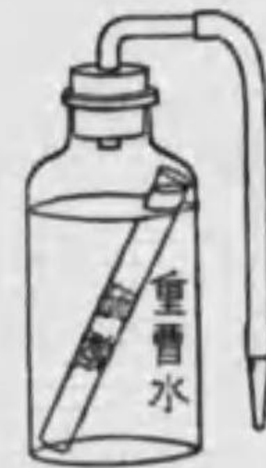
第27圖 消火器の原理を示す
