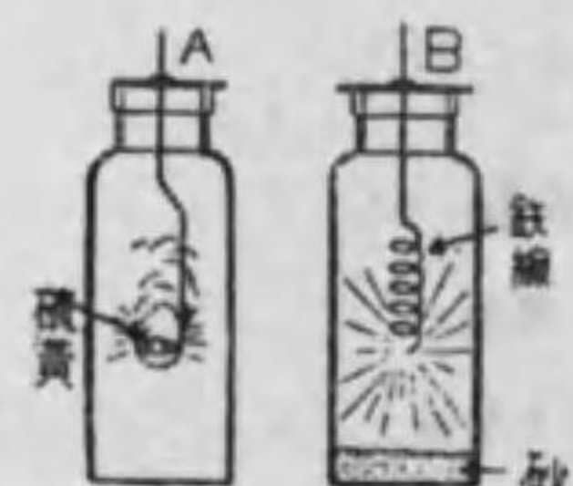
第8圖 (A) 酸素中、硫黄の燃焼する實驗 (B) 酸素中で鐵線の燃焼する實驗
