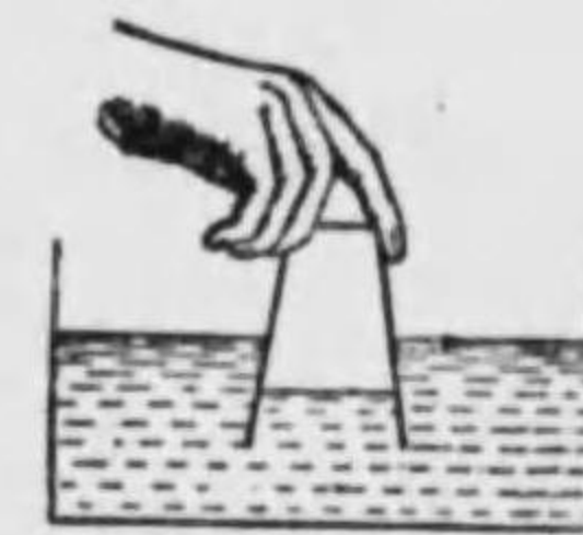
第1圖 空氣があるために水はコップの中へ侵入しない
