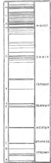
Рис. 15. Распределение цвѣтовъ въ спектрѣ съ темными линиями А, В, С, D и т. д.
