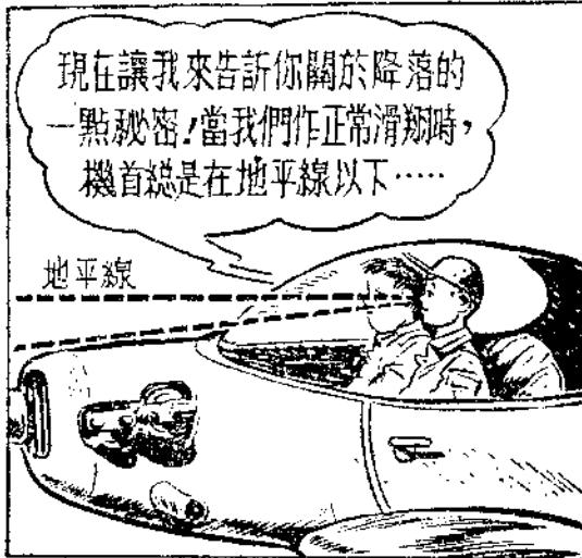
現在你向四周望開去，你將見你的飛機好像飛行在一隻碗裏，在飛機的直下方是碗的中心。你可以把地平線作為一邊，對某地的視線作為另一邊，而測量其間的角度。在我們直下的地方是  $90^\circ$ ，那邊的高房子大約是  $30^\circ$ 。
