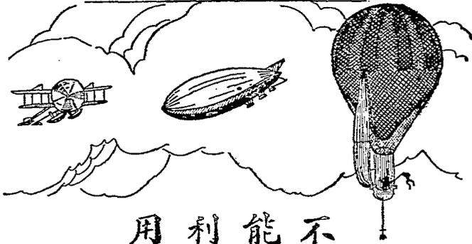
從前我們要到空中去，只能坐在氣球的籃裏，進退不能自由。後來發明一種飛艇，能在空中自由進退，比氣球便利得多。以後又發明一種飛機，用翼和推進器做升降進退的器具。從此人在空中來往，更加便利了。
