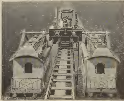
Fig. 1. - Ferrocarril de gravedad. - Los vagones y el camarote del maquinista
