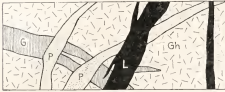
Fig. 1. Verschiedenalterige Eruptivgänge im Hornblendegranitit (Gh) von Meißen in Sachsen: heller Granitit (G), Granophyr (P) und Lamprophyr (L). Nach Sauer.
