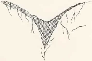
Fig. 4. Dolinenbildung durch Sickerwasser in massigem klüftigen Kalk. Nach Cvijič.
