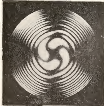
Fig. 19. Eine rechtsdrehende Platte über einer linksdrehenden. Fig. 20. Eine linksdrehende Platte über einer rechtsdrehenden. Quarz. Vierfache Airysche Spiralen.
