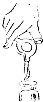
第85圖 力偶的應用 f, f' 為方向相反的 平行力即力偶
