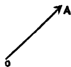
第81圖 力的圖示O，應力點；OA，方向；OA的長度表示力的大小
