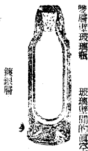
第54圖 熱水瓶的構造
