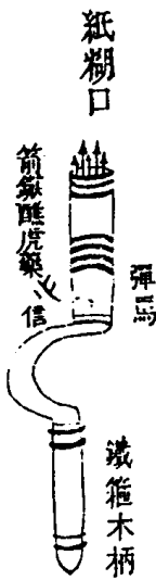
貓竹筒長二尺五寸用牛筋 芋麻鐵線生漆魚膠纏定
