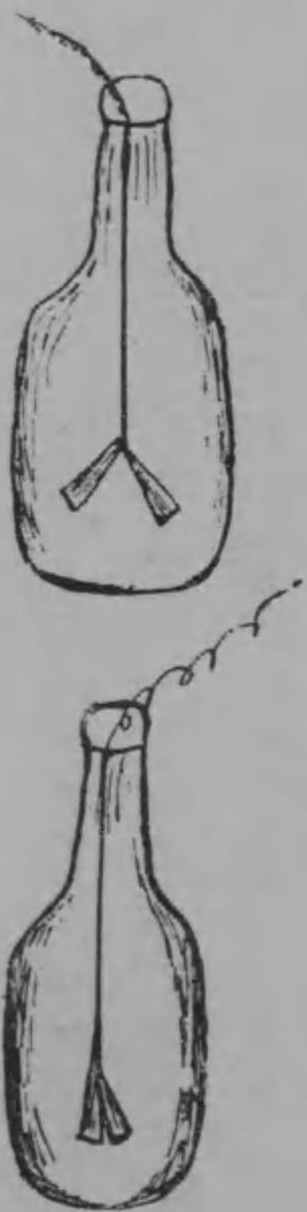
金箔檢電器の金箔片が開いた圖と開かない圖
