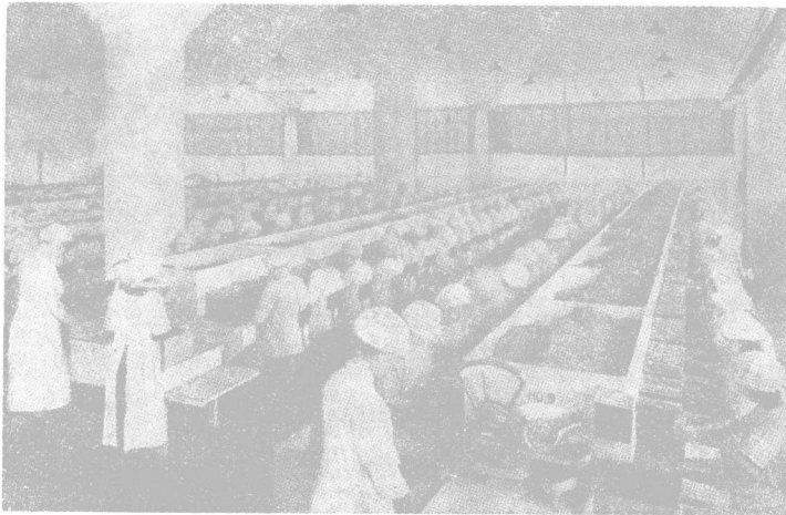
第一三五圖 加利福尼亞胡桃生產合作社中央工場胡桃肉之清淨及分級。
