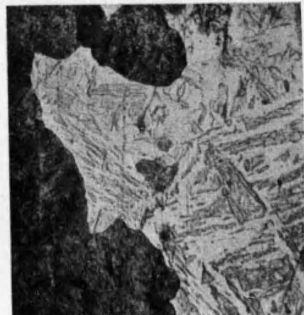
No. 47. 0.9% C 鋼 (×1000) 760°C より温湯中に焼入せるもので粗粒破とその一部は波來土となれる事を示す。Sorbitic pearlite とも稱すべきものである。腐蝕液同上、
