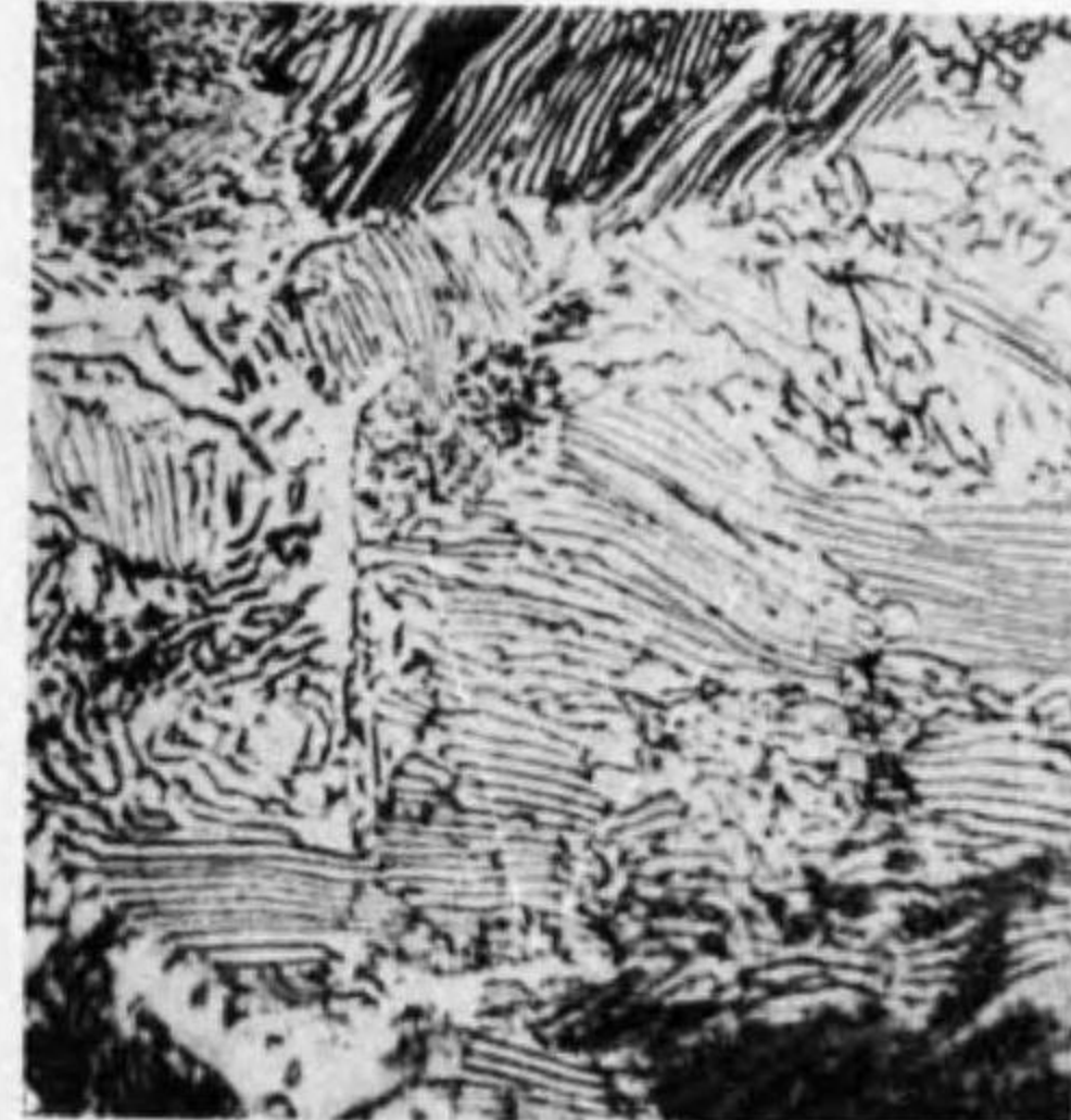
No. 41. 同上針金を標準化したもので層状波來土と少量のフェライトを示す。(×1000) 抗張力 49 噸/時 2
