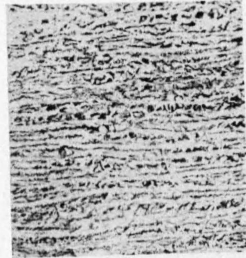
No. 36. 0.2% C 軟鋼板 (×100) 縦断面を示したもので、組織が横に走り、壓延された方向が之でよく示されてゐる。1% 硝酸のアルコール溶液にて腐蝕す。
