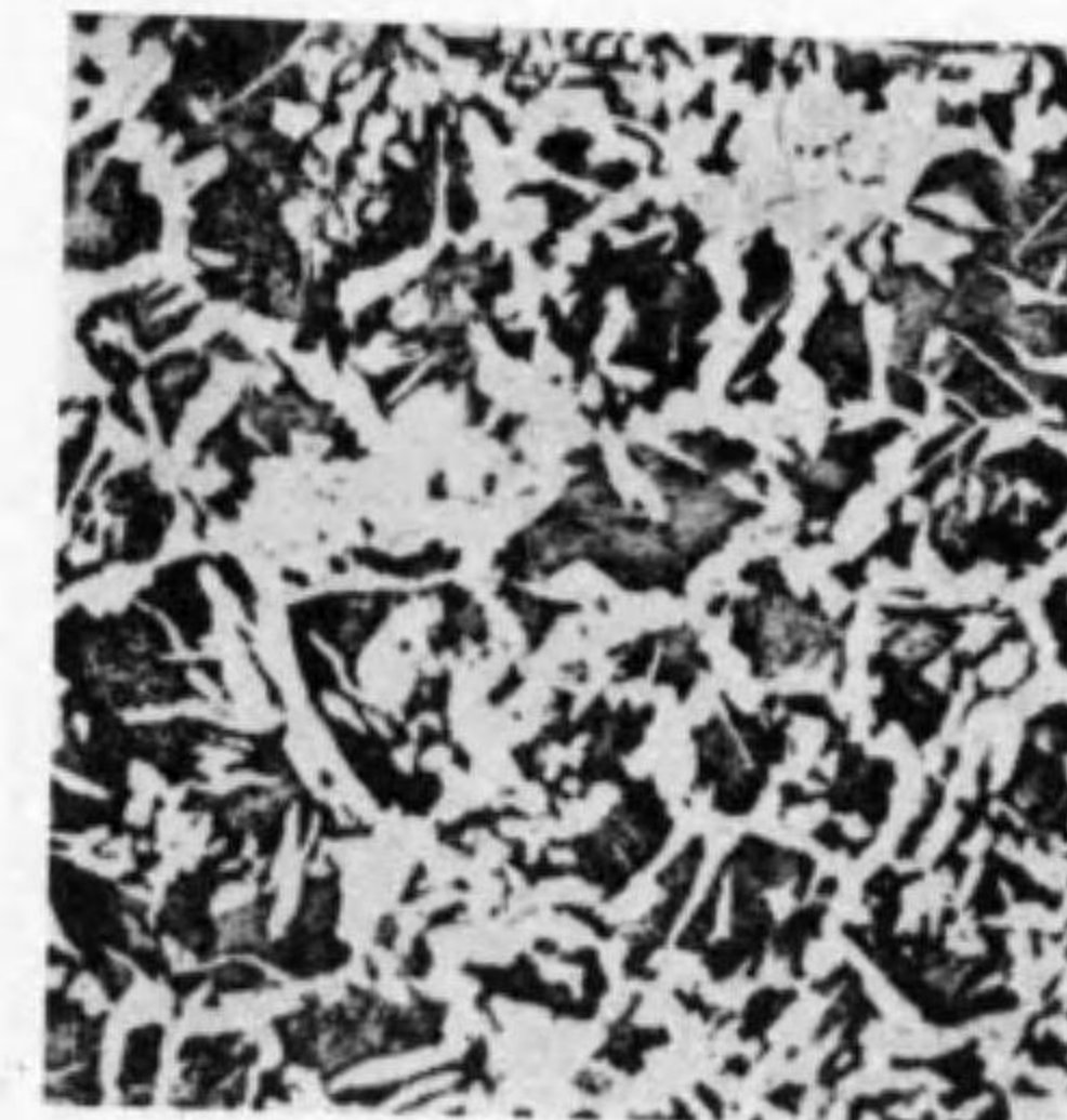
No. 30. 0.45% C 鋼 (×100) 標準化せる組織を示す。波來土の地益々多くなる。腐蝕液同上。
