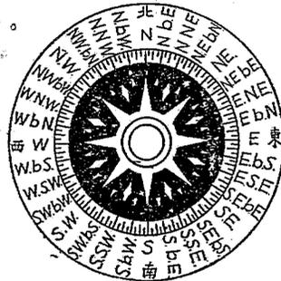
如右圖中  $OP$  之方向為北偏東  $35^\circ$ ，簡寫為  $N35^\circ E$ ，又  $OQ$  之方向為南偏東  $80^\circ$ ，簡寫為  $S80^\circ E$ 。今  $\angle EOQ$  等於  $10^\circ$ ，比  $45^\circ$  小，故  $OQ$  之方向有時亦可稱為東偏南  $10^\circ$ ，簡寫為  $E10^\circ S$ 。
