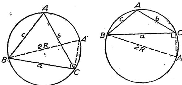
上左圖中， $A$  為銳角， $A' = A$ ， $\sin A' = \sin A$ ，在上右圖中， $A$  為鈍角， $A' = 180^\circ - A$ ， $\sin A' = \sin(180^\circ - A) = \sin A$ 。
