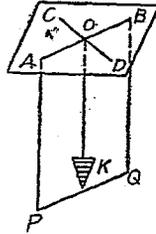
(ii) 水平線 過某點垂直於過此點之鉛垂線之直線，稱為過此點之水平線。如直線  $AB$ ,  $CD$  等為過  $O$  點之水平線。
