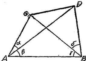
則  $\angle ACB = 180^\circ - (\alpha + \beta + \gamma)$ ， $\angle ADB = 180^\circ - (\beta + \gamma + \delta)$ 。
