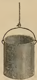
(Fig. 26.) Drague métallique, modèle Forel.
