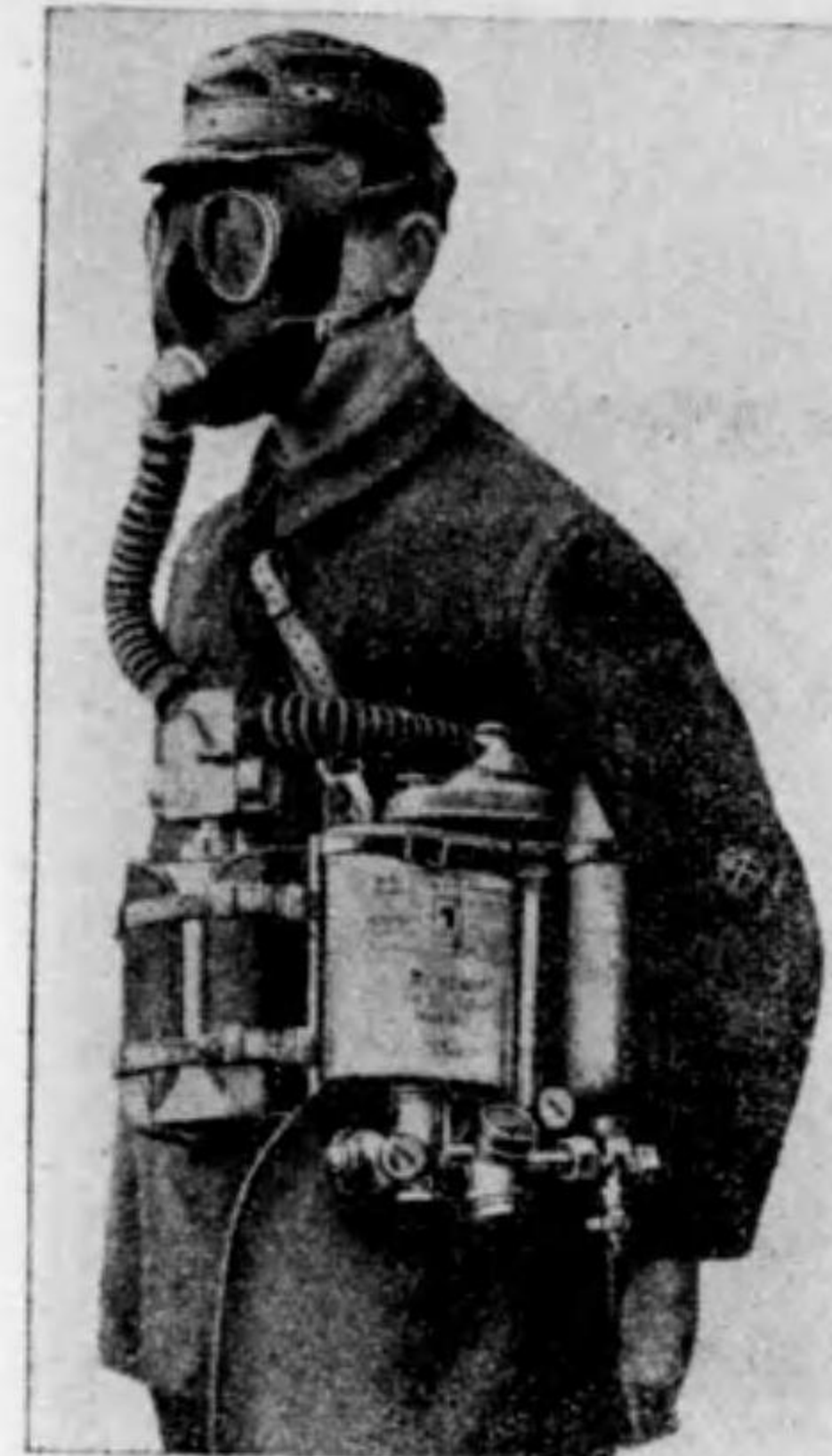
酸素瓦斯吸入及ビ有毒瓦斯濾過ノ兩作用ヲ併有スルモノ。
