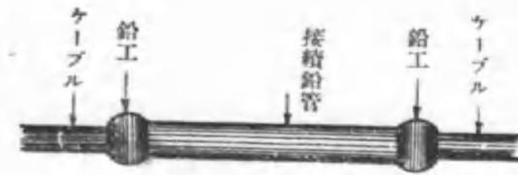
第146圖 直線形鉛工
