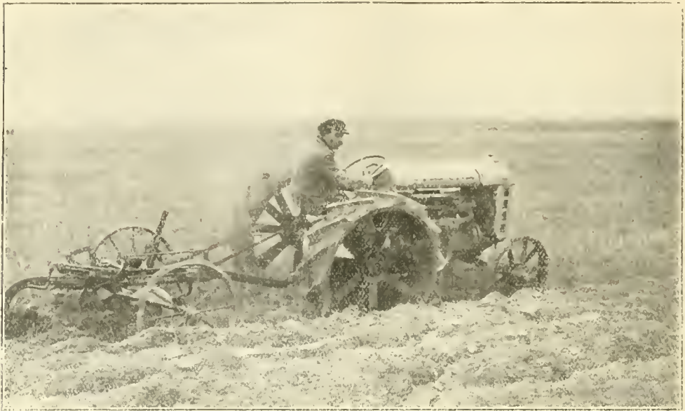
Fig. 198. — Tracteur Fordson, de la force de 22 HP.
