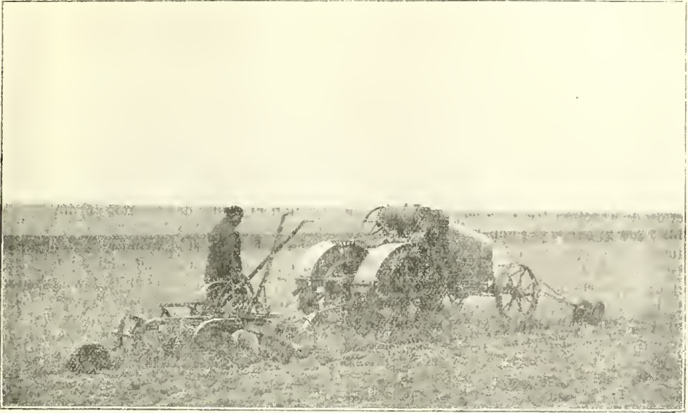
Fig. 194. — Tracteur « International » de la force de 16 HP.
