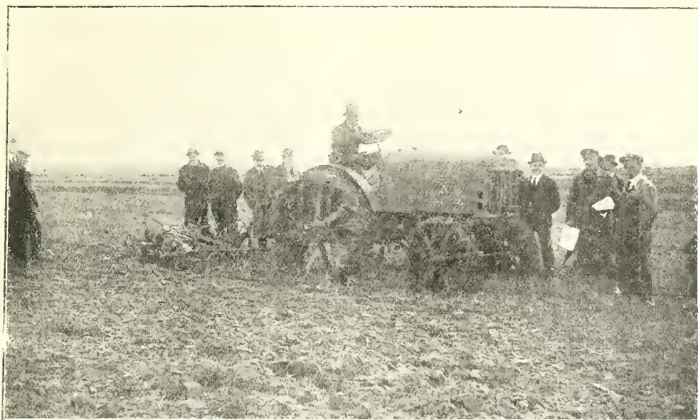
Fig. 196. — Tracteur « Fiat », de la force de 18-25 chevaux.
