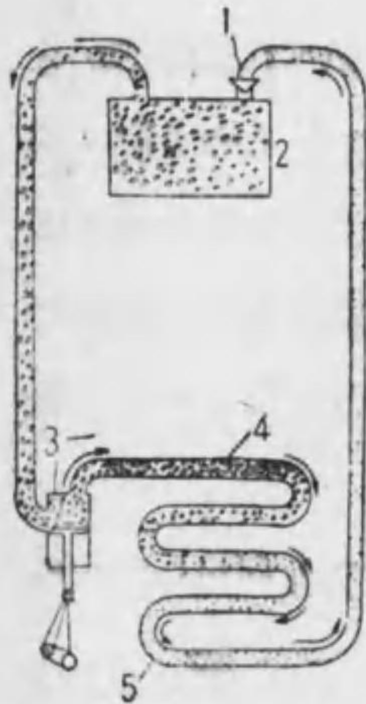
第4・6圖 家庭用電氣冷蔵庫 ①調節弁 ②蒸溜器 ③壓縮機 ④凝結器 ⑤蓄液部
