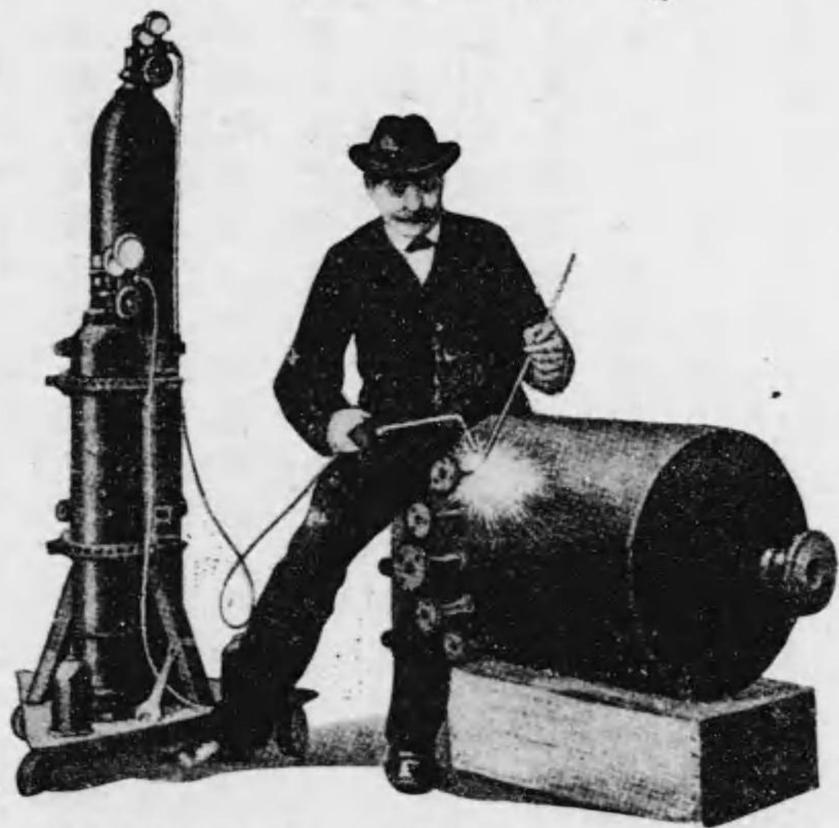
よに熱高其めしせ出噴りよ管吹を斯瓦合混のと素水と素酸 にり代の素水)る切き焼を板鐵き厚は或ち穿を孔に鐵てり (りあこころゆ用をンレチセア
