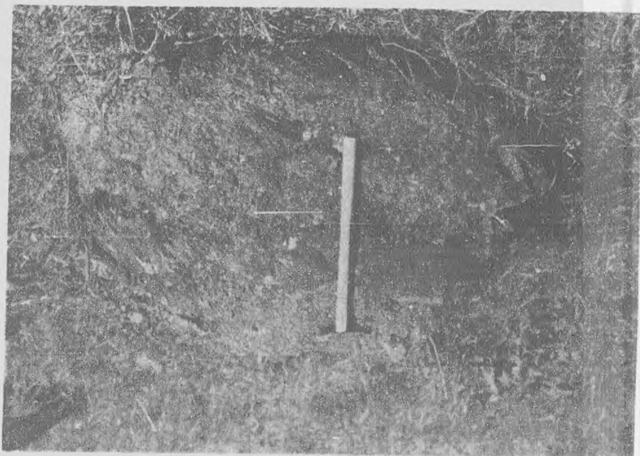
第一圖 大連山東北段柎山之變質高家邊頁岩，破碎之後復行粘合之角礫岩。
