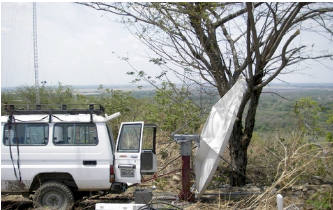
Figura EcLD 9: Instalación de la antena en El Baúl. La antena está apuntando 1° hacia arriba debido a la iluminación desviada en 22,5°
