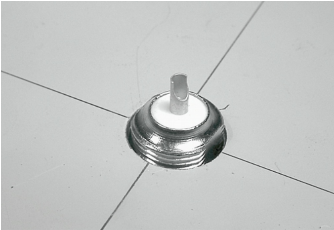
Figura CA 10: El conector N debe encajar exactamente en la perforación
