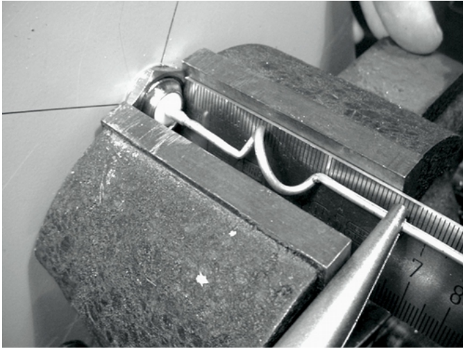
Figura CA 15: Estirar los anillos con mucho cuidado para no raspar la superficie del alambre con las pinzas
