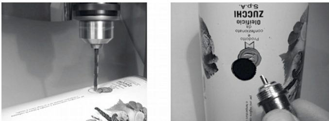
Figura CA 24: Taladre con cuidado un agujero piloto, luego use una mecha más grande para terminar el trabajo
