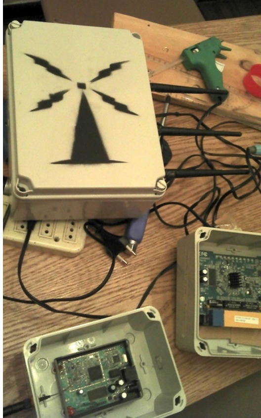
Figura RM 4: Enrutadores de bricolaje (DIY) para exteriores contruidos a partir de dispositivos SOHO comerciales (la foto muestra ejemplos basados en TP-Link WR741 y WR941, y en un enrutador Fonera
