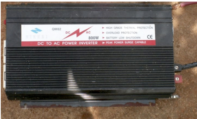
Figura EA 4: Convertidor DC/AC. Inversor con potencia máxima de salida de 800 W
