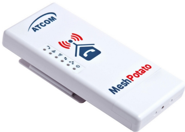
Figura RM 3: Mesh-Potato, un enrutador WiFi de exteriores con VoIP (con un puerto FXS para conectar un teléfono analógico www.villagetelco.org )
