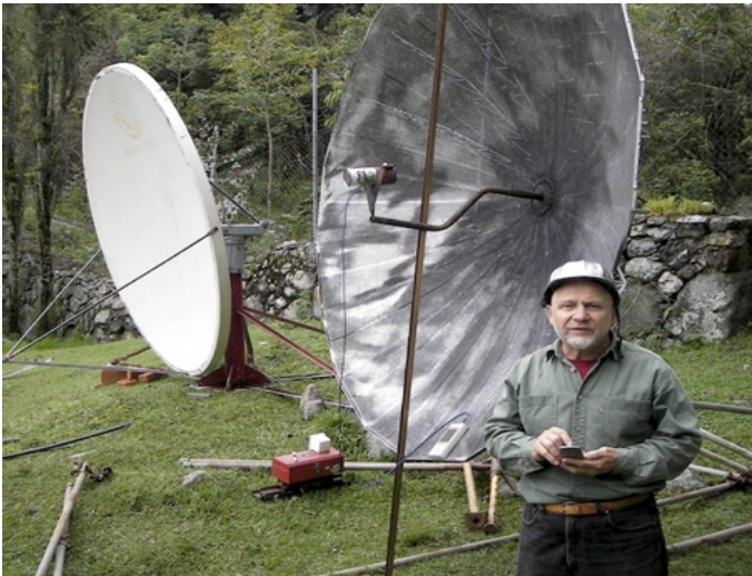
Figura EcLD 6: Hallando el foco de la antena con el iluminador de 2.4 GHz
