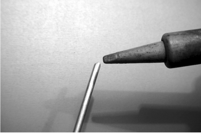
Figura CA 25: Estañe el extremo del alambre antes de soldarlo
