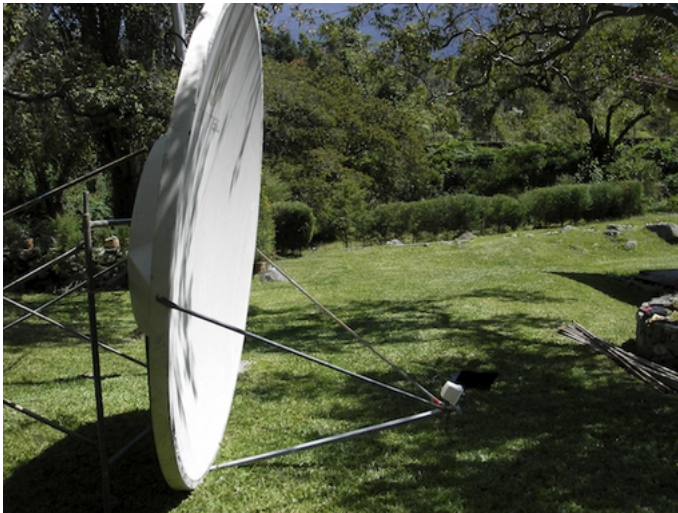
Figura EcLD 4: Reflector de 2,4 m con iluminación excéntrica y una antena de 12 dBi en su punto focal, mirando 14° hacia abajo. El ángulo real de elevación es de 8° hacia arriba
