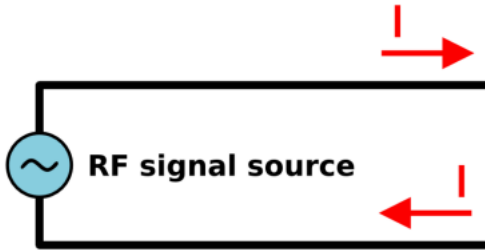
Figura ALT 2: Línea de transmisión bifilar
