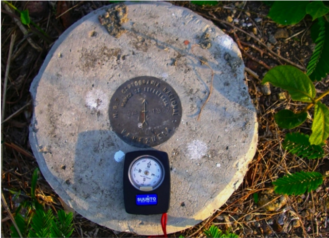
Figura IE 2: Diferencia entre el Norte Magnético y el Geográfico en El Baúl, Venezuela, 2006
