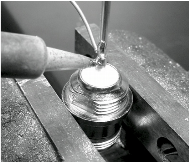
Figura CA 26: Suelde el alambre a la copa dorada del conector N
