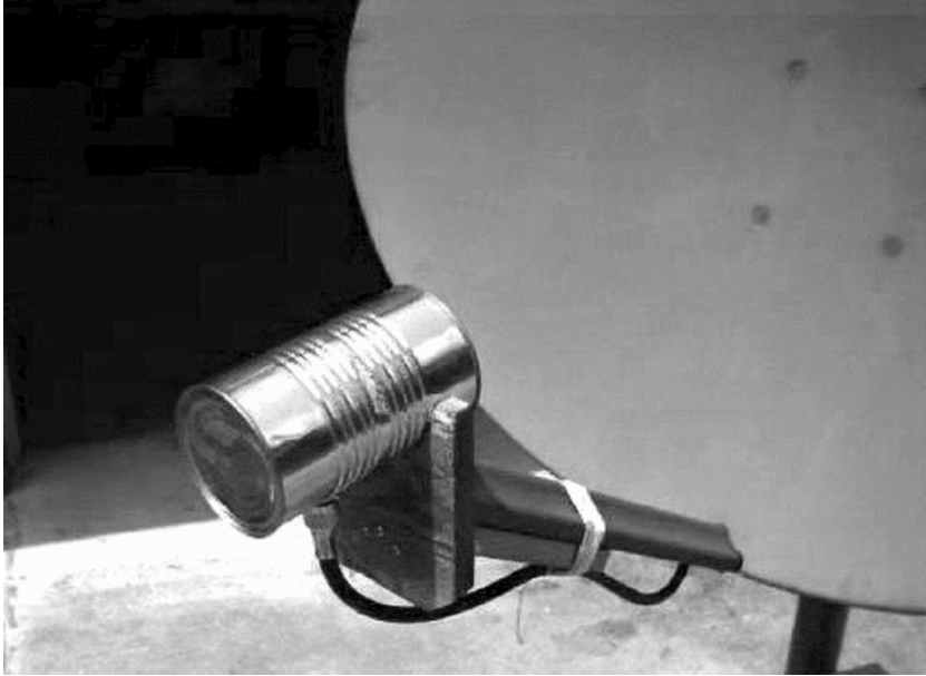
Figura ALT 13: Antena bocina hecha con una lata de comida
