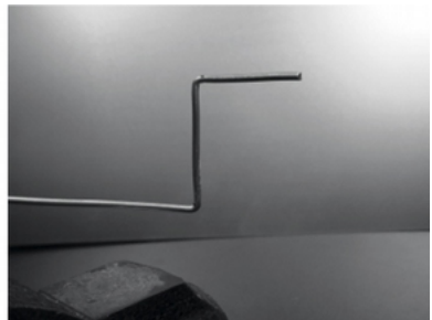
Figura CA 4: Doble el alambre en forma de “Z”
