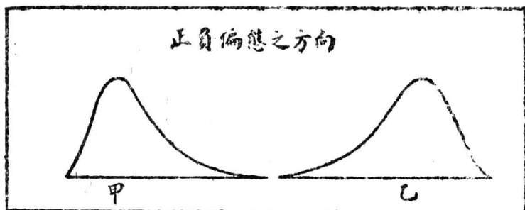
偏態之類及曲線，甲爲正偏態（衆數小於中位數——曲線長尾向右）。乙爲負偏態（衆數大於中位數——曲線之長尾向左）
