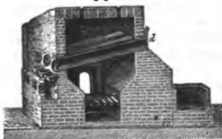
füllen. Wie die Figur 1194 zeigt, sind die Röhren auf der einen Seite b geschlossen bis auf kleine Oeffnungen, durch welche das Metall in die Kapseln fließen kann. Diese stehen auf einer besonderen Feuerung k, welche zum Zweck hat, die Kapseln zu erhitzen, so daß das geschmolzene Metall flüssig bleibt und mittelst eiserner Löffel aus den Kapseln geschöpft und in Formen gegossen werden kann.
