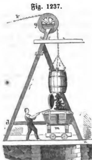
Die Bahnstrecke, welche gerade über den Schacht hinwegläuft, würde das Herausholen der Tonnen hindern, diese Strecke ist mithin in der Regel nicht über dem Schacht zu finden, sondern nur für den Augenblick vor- handen, daß die Tonne bereits aus dem Schacht heraus und der Wagen unter der Tonne befindlich ist.
