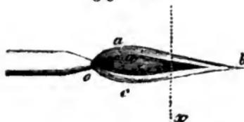
man die Tasse hält, ist nicht gleichgültig. Die Figur 1189 zeigt uns eine äußere Umhüllung abc, welche einen dunkleren Theil ac umgibt. In diesem Innern befindet sich das aus der Oeffnung o der Glasröhre strömende Gas unverändert, nur an der Außenseite brennt es, am lebhaftesten an der äußersten Begrenzung, wo
