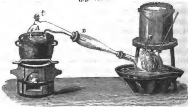
die zu verdampfende Flüssigkeit einfüllen, ohne daß der Hals der Retorte dadurch verunreinigt wird. Das Destillat, welches sich in der Vorlage C sammelt, soll eigentlich nur reines Wasser sein, muß aber doch untersucht werden, weil die Möglichkeit, daß sich Chlor mit Arsen in Verbindungen darin findet, wirklich vorhanden ist.
