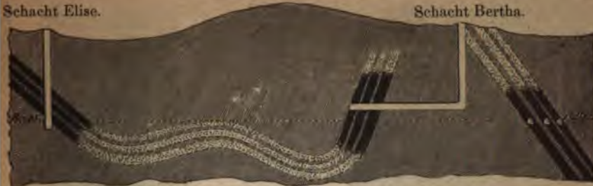
Profil durch den Elisenschacht und den Berthaschacht.
