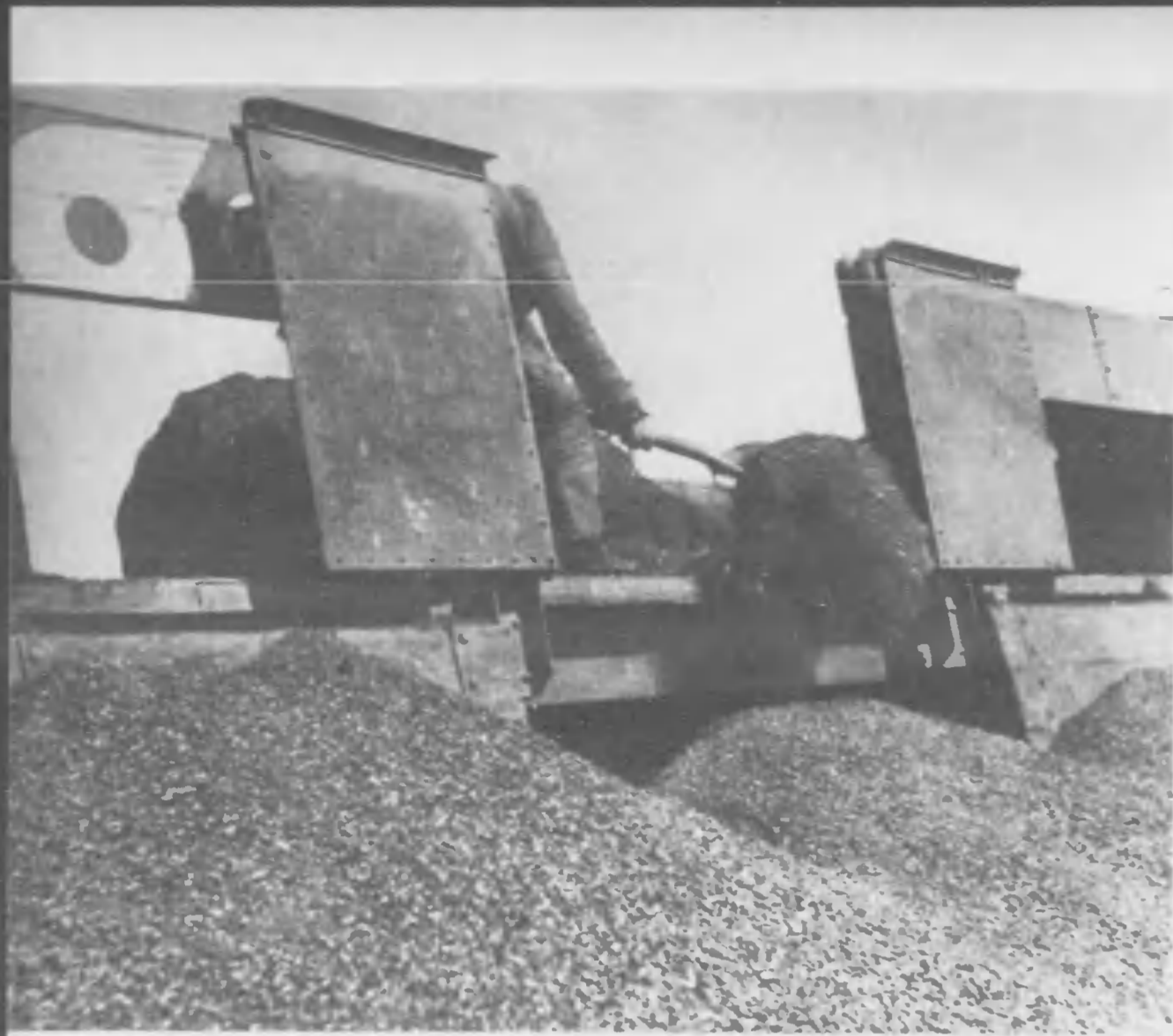
貨車で運ばれてきた大同炭の一通はこゝで選別して積み込まれて目的地に向ふ 選別機を通過して選別された石炭はこゝから トラックに積み込まれて各地へ輸出される
