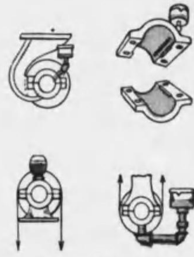
第四十一圖—ドライヤー フェルト ロール ベヤリング。A—燈心給油器を備ふる上部フェ ルト ロール ベヤリング(牽引上方向)。B— 同上ベヤリングを備ふる下部フェルト ロ ールベヤリング。C—燈心給油器を備ふる下部 フェルト ロール ベヤリング(牽引下方向)。
