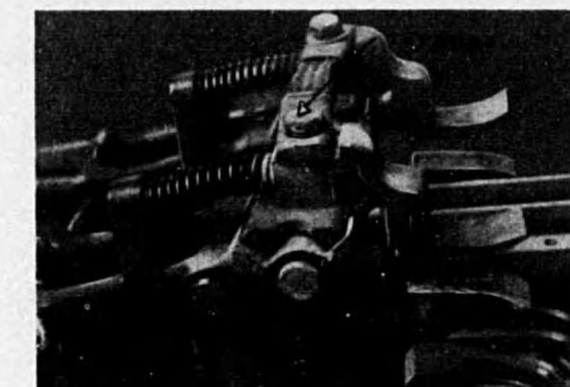
其 一 第二十五圖 ライン・ブレーカー・リード取付捻子弛緩のためレバー・ピン・チップホルダー及ベヤリング焼損せるものを示す 其 二
