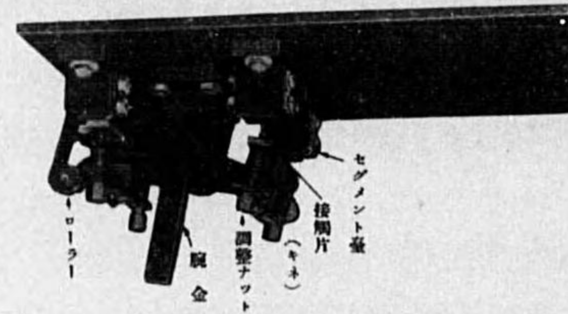
第二十二圖 ノツチング・スキッチ (150型に從來使用せしもの)
