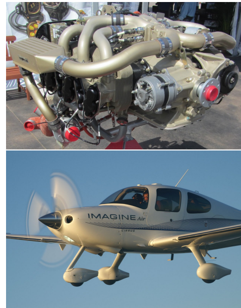
FIGURE 10.31 – Moteur six cylindres essence à injection Continental IO-550 de 300 ch, en fabrication depuis 1983. Il équipe entre autres l'avion Cirrus SR22 .
