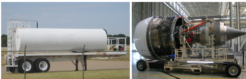
FIGURE 1.2 – Une remorque, de puissance nulle ( \dot{Q} = 0 \text{ W} ) mais capable de restituer beaucoup d'énergie. La combustion de 20 t de kérosène dégage environ Q = 800 \text{ GJ} sous forme de chaleur ; Un turboréacteur à soufflante Trent 900 , de très grande puissance (capable de fournir \dot{W} = 14 \text{ MW} à un avion de ligne) mais dépourvu d'énergie (0 J).
