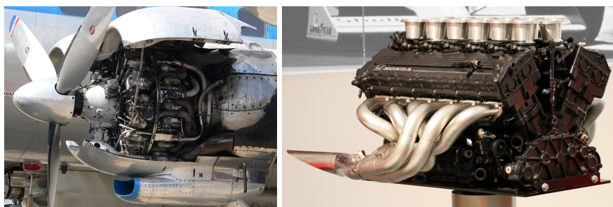
FIGURE 10.6 – À gauche, un Curtiss-Wright R-3350 Duplex-Cyclone (1950) de 3 500 ch à 18 cylindres disposés en deux étoiles successives. Quatre de ces moteurs équipaient le long-courrier Lockheed Super Constellation .
