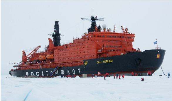
FIGURE 9.28 – Le 50 Let PODEBY, brise-glace de 25 000 t à propulsion nucléo-turbo-électrique (deux réacteurs de 171 \text{ MW}_{\text{chaleur}} , trois moteurs de 17,6 \text{ MW}_{\text{méch.}} ). Sa construction a débuté en 1989 mais il n'est entré en service qu'en 2007.
