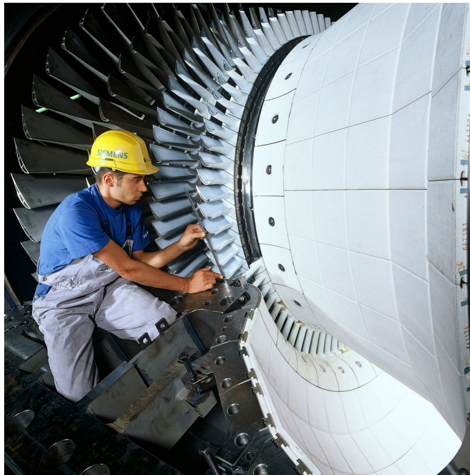
FIGURE 10.12 – Turbine d'un turbomoteur générateur. La turbine photographiée, une Siemens SGT5 , peut accepter un débit d'air et d'eau de 690 \text{ kg s}^{-1} . Elle transmet une puissance à l'arbre d'environ 500 MW.
