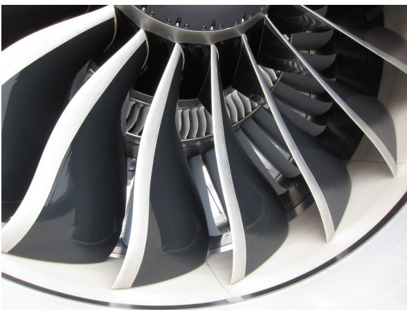
FIGURE 4.17 – Entrée d'air d'un des quatre turbo-réacteurs General Electric GENX-2B équipant un Boeing 747-8. Les pales bicolores de la soufflante sont visibles au premier plan ; derrière, le flux d'air est divisé entre l'entrée du compresseur (intérieur) et les stators redresseurs du flux froid (extérieur).
