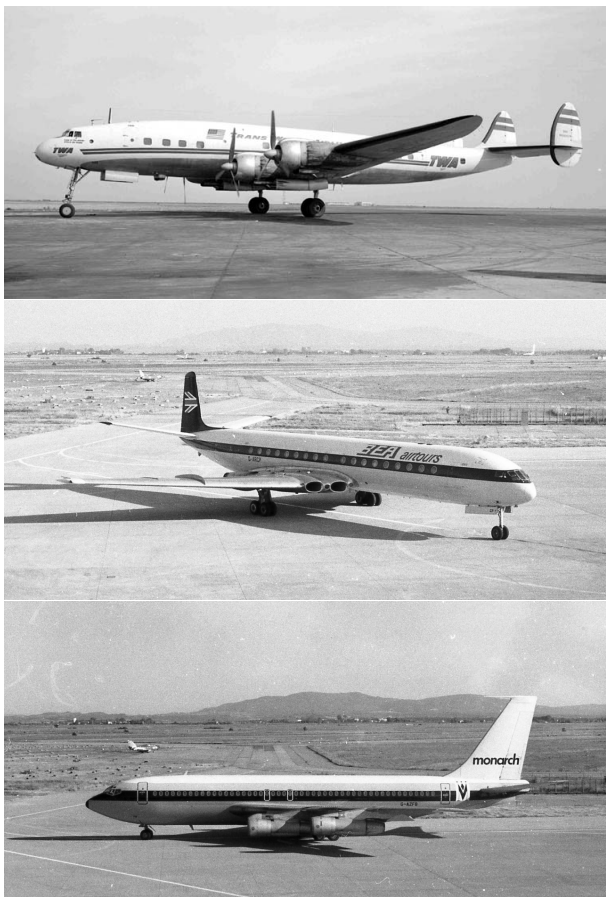
FIGURE 9.26 – De haut en bas : Le Lockheed Constellation (1943), aboutissement de l'ère de l'aviation à hélice : quatre moteurs Wright Duplex-Cyclone surcompressés à 18 cylindres chacun, capable de franchir 3 700 km à 500 km/h. Le De Havilland Comet (1949), premier avion de ligne à réaction : quatre turboréacteurs Halford Ghost monoflux, capable de franchir 2 400 km à 740 km/h. Le Boeing 707 (1957), dont la configuration et les performances préfigurent celles de tous ses successeurs depuis : quatre turboréacteurs Pratt & Whitney JT3C monoflux, capable de franchir 4 300 km à 900 km/h.
