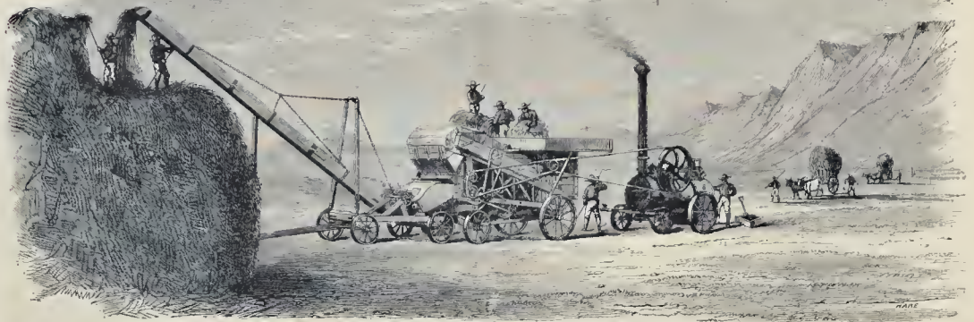
MÉCANIQUE AGRICOLE. — Machine à battre, à vapeur, de MM. Ransomes et Sims.
