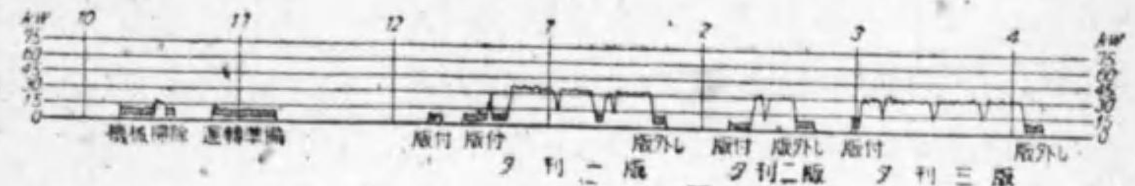
第 251 圖 輪轉機 1 臺消費電力曲線の例
