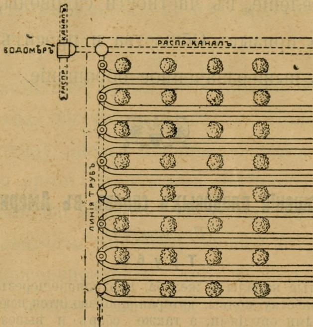
Рис. № 21. Схема орошенія сада при помощи трубъ.
