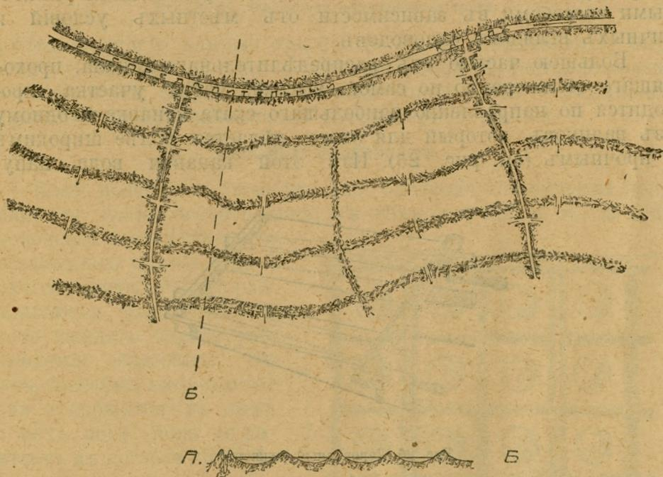
Рис. 27. Устройство чеховъ на крутомъ скатѣ.
