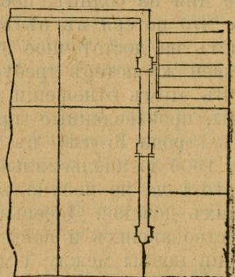
Рис. 28. Устройство чекъ на ровной мѣстности.
