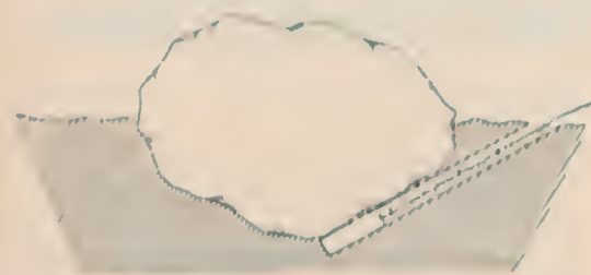
Fig. 2 Carga subterrânea em tubo com fio de ignição
