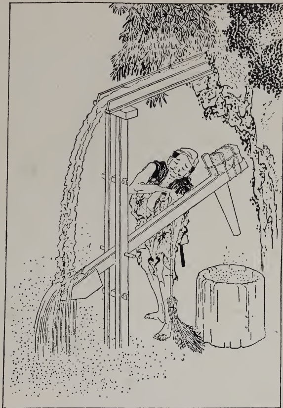
Abb. 18. Reiskämmer, der den Hebel durch Wasserdruck in Betrieb setzt.
