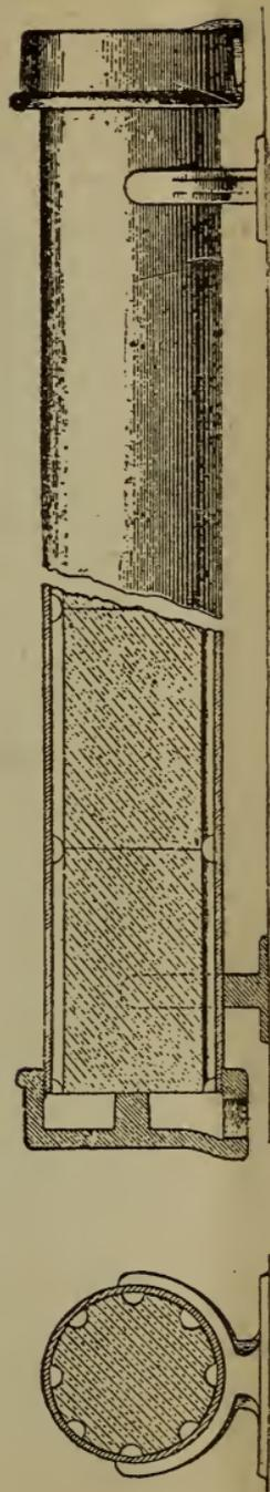
FIG. 30. CYLINDER CONTAINING BRICKS FOR STORING HEAT.
