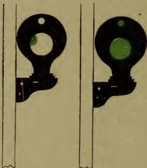
FIG. 117B. THE DISC TYPE OF SEMAPHORE.
