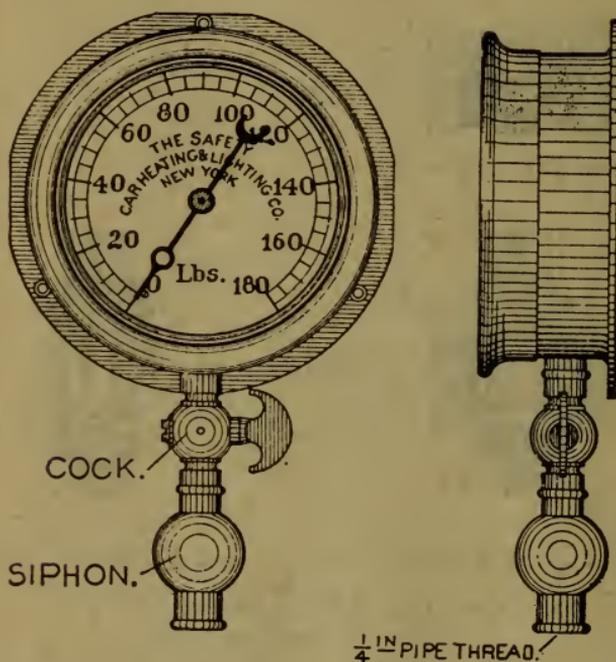
FIG. 17. GAUGE FOR STEAM HEATING.
