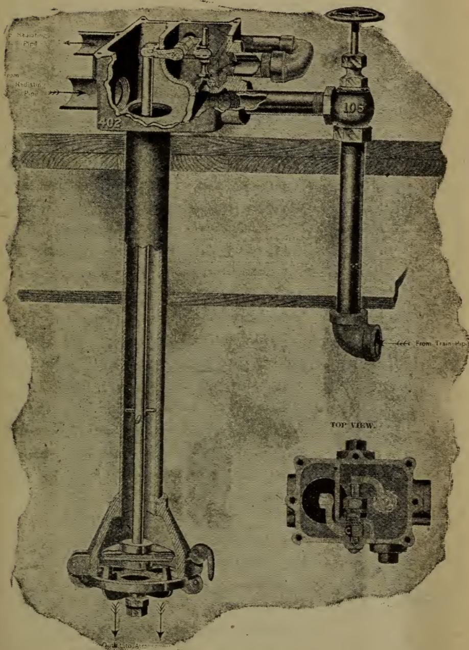
FIG. 37. VAPOR HEATING—SECTIONAL VIEW.
