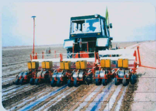
3膜12行气吸式精量铺膜播种机(成果水平国际先进,2005年国家重点新产品。一次作业完成铺设滴灌管、铺膜、膜上打孔精量播种等8道作业程序)
