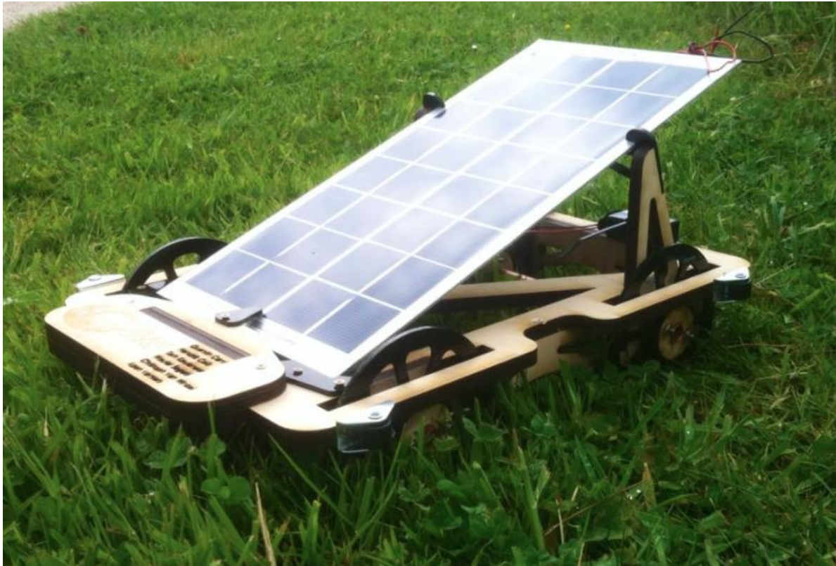
Foto 8: Het zonnepaneel bevestigd op de SSV.
