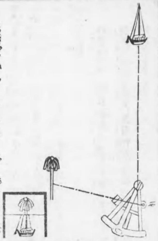
右得る處の各角度を以て八線用法に依て各相距離の數と求む然るに用うる處の測器にキスマントヨクタントハ皆西法の六算を用ふるなり仍て其角度分秒の端數を帶る時ハ六分を以て其端數を除き一度を百分とする處の數ハ八線十分表の眞數表 在前編 或ハ對數表 在后編 第十卷
