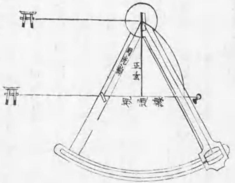
圖の如く視軸の位置ハ對鏡の中央を以て回光線より卦限儀に在てハ四十五度の角を成り紀限儀ハ六十度の角を成りて視通線に成り故に卦限儀の對鏡ハ儀軸の外に在て紀限儀ハ必に儀軸の中央限度線の上を在り仍て回光線と半径とする處の正弦
