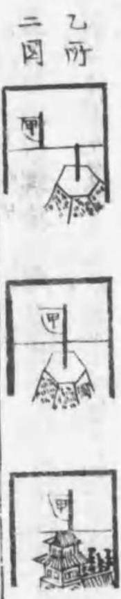
茲に於て戊の螺旋を固め遊表を停め其弧度を計り八十九度あり乙右角に此処に目印を残し置甲の臺場へ移り測器を平らうに持ち遊表と初度線定め視軸より對鏡と望ミ丁の破船を見る上の玻璃と下の鏡面と齟齬して上圖の如く一様なるに故に丙の螺旋を伸縮し視差を正し中國の如く上下合一に成し遊表を徐々に向へ運らすに甲乙の臺場と正しく一直線に在る沖中の目印枕下の鏡面を忽然と現れ上の玻璃を透光する破船と合一に成るに下圖の如し
