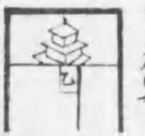
此時戊の螺旋を固め遊表を停め其弧度を計り三十九度三十六分あり甲角は此處に目印を残り開地乙所へ移り其距離を計り五十間あり甲乙辺と長間此處にて又甲所の如く測器を平らうと持ち遊表を初度線と定め甲所の殘目印を見よと標的の夜燈を回光を求めんと欲する其距離廣大くと測器の限度を過る其業行はば仍て標的の夜燈と乙所と真正直線と成る處の正後の目印を求め是を種々其餘角を求るより先正後と在るの杉樹を仮目印し反して此方に向ひ視軸より對鏡を望み杉樹を見よと玻璃を見透る處と鏡面を移
