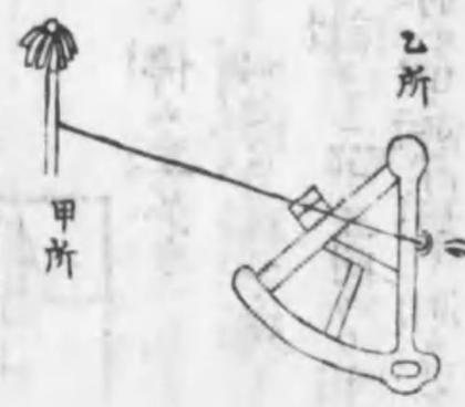
対鏡に現る如玻璃に見透る處に鏡面を移る象と上圖の如く廻結して合せし故に丙の螺旋を或伸し或縮め上下一置に成ると下圖の如し
