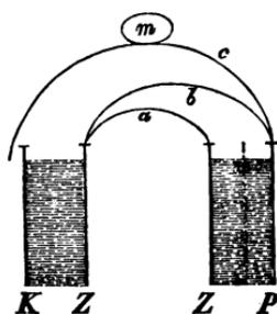
Man verknüpfe durch ein Draht  $\alpha$  die Zinkplatten beider Ketten, und durch einen Draht  $\beta$  die Platinplatte der constanten Kette mit der Zinkplatte der inconstanten. Endlich führe man noch einen Draht  $c$ , der irgendwo einen empfindlichen Multiplicator  $m$  einschließt, von jener Platinplatte zu der Kupferplatte oder überhaupt der negativen Platte der inconstanten Kette, ohne ihn jedoch in dauernder Verbindung mit derselben zu halten.
