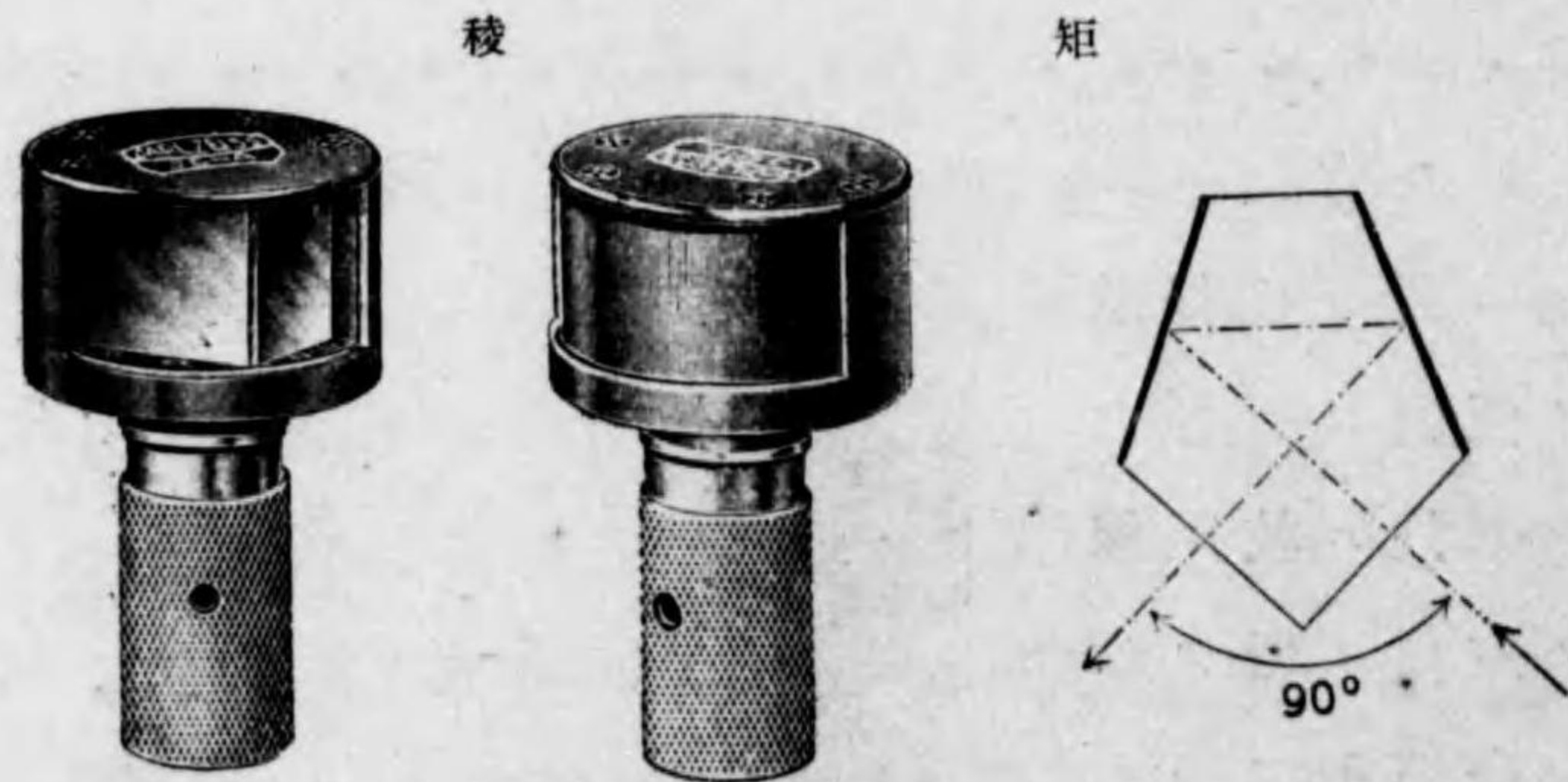
圖ハつあはす製稜矩ニシテ, 其把柄ヲ廻ハセバ其被套管ヲ以テ稜鏡ヲ包藏スルコトヲ得(第十四圖). 其光線
