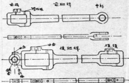
偏心桿及搖桿拆完後，即可開始拆前後聯桿。拆時先拆去三塊襯鐵上的螺絲及三聯銷的螺帽——拆時須先拆下開尾銷——打下三塊襯鐵，拿下三塊後塊銅瓦。以後用擰棍往前擰動聯桿，即可拿下三塊前塊銅瓦。再用擰棍擰動主動輪使曲拐銷及偏心曲拐在一平面上。往外板聯桿，打出三聯銷，拿下前聯桿，次將後聯桿的後端拿出，前端即可順着曲拐銷及偏心曲拐取出。最後拆去油盒蓋及油調針。
