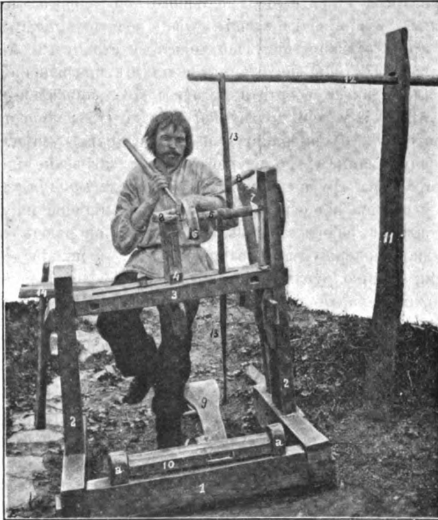
223 Василь Шкрибляк при токарни. 1. Підстава; 2. стовпц; 3. огниво; 4. заць; 5. валок; 6. матерьял на ракву; 7. решітце; 8. кривули; 9. постіл; 10. воротило, яке ходить у жабках а. а.; 11. стовп; 12. жердка; 13. ремінь; 14. сідець.
