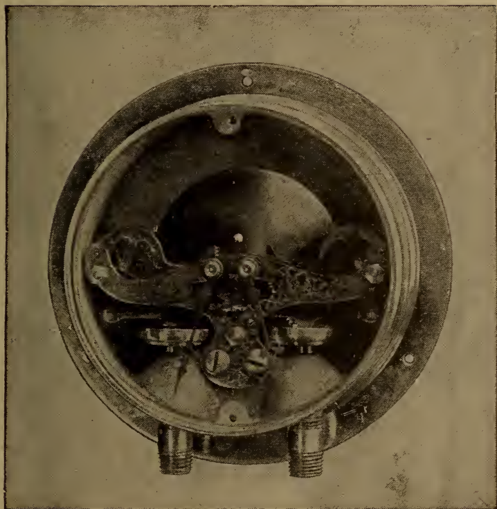
FIG. 32. Utica Duplex Air Gauge.
