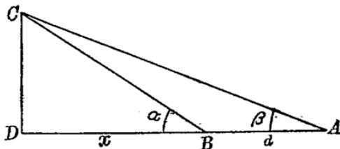
退後  $d$  尺, 在  $A$  處測得  $C$  的仰角  $\beta$ ; 若  $A, B, D$  在同平面內求江寬幾尺.
