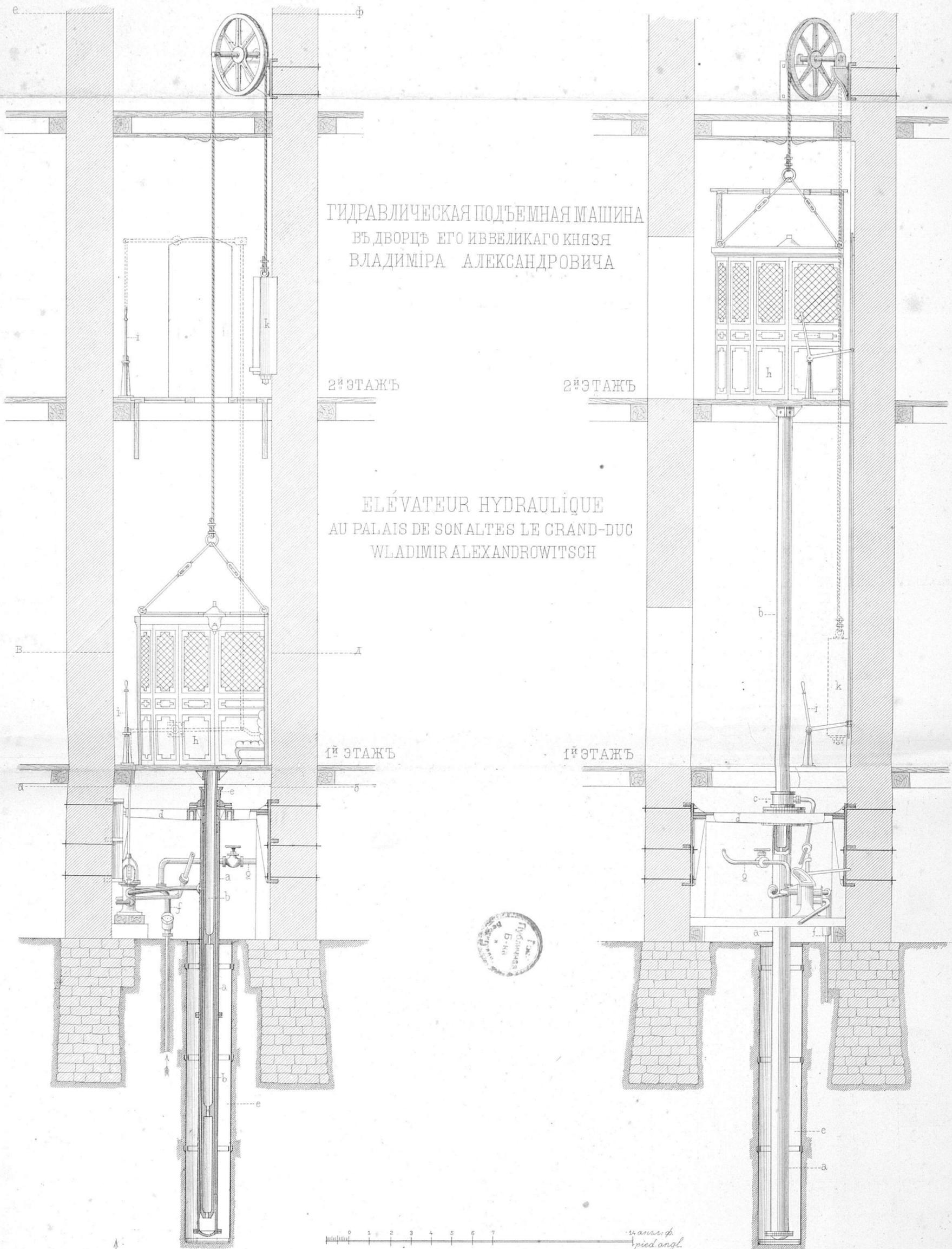
ГИДРАВЛИЧЕСКАЯ ПОДЪЕМНАЯ МАШИНА
