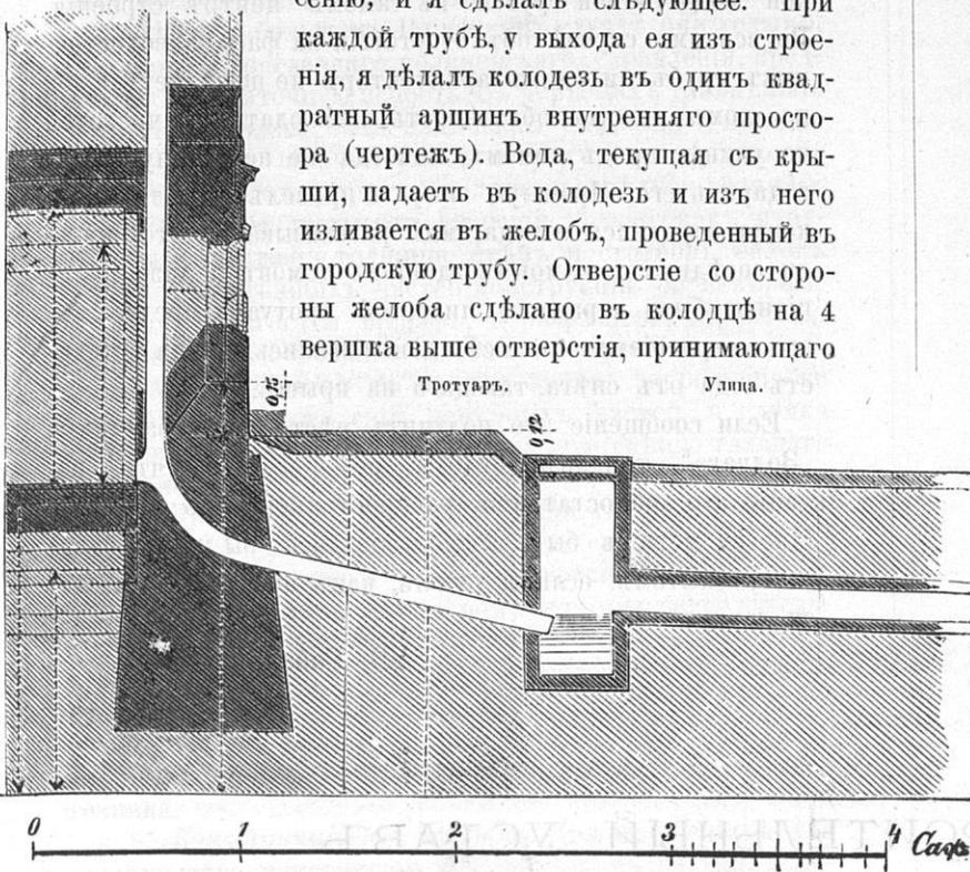
воду изъ водосточной трубы. Такимъ образомъ отверстіе со стороны дома должно быть всегда ниже уровня воды въ колодецѣ, что и составляетъ препятствіе для прониканія атмосфернаго воздуха въ вертикальную часть трубы, находящуюся въ домѣ и оканчивающуюся на крышѣ воронкой.
