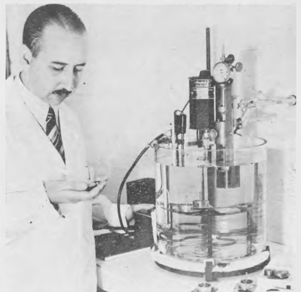
Ensayos reológicos con el viscosímetro de cilindros coaxiales de caída
