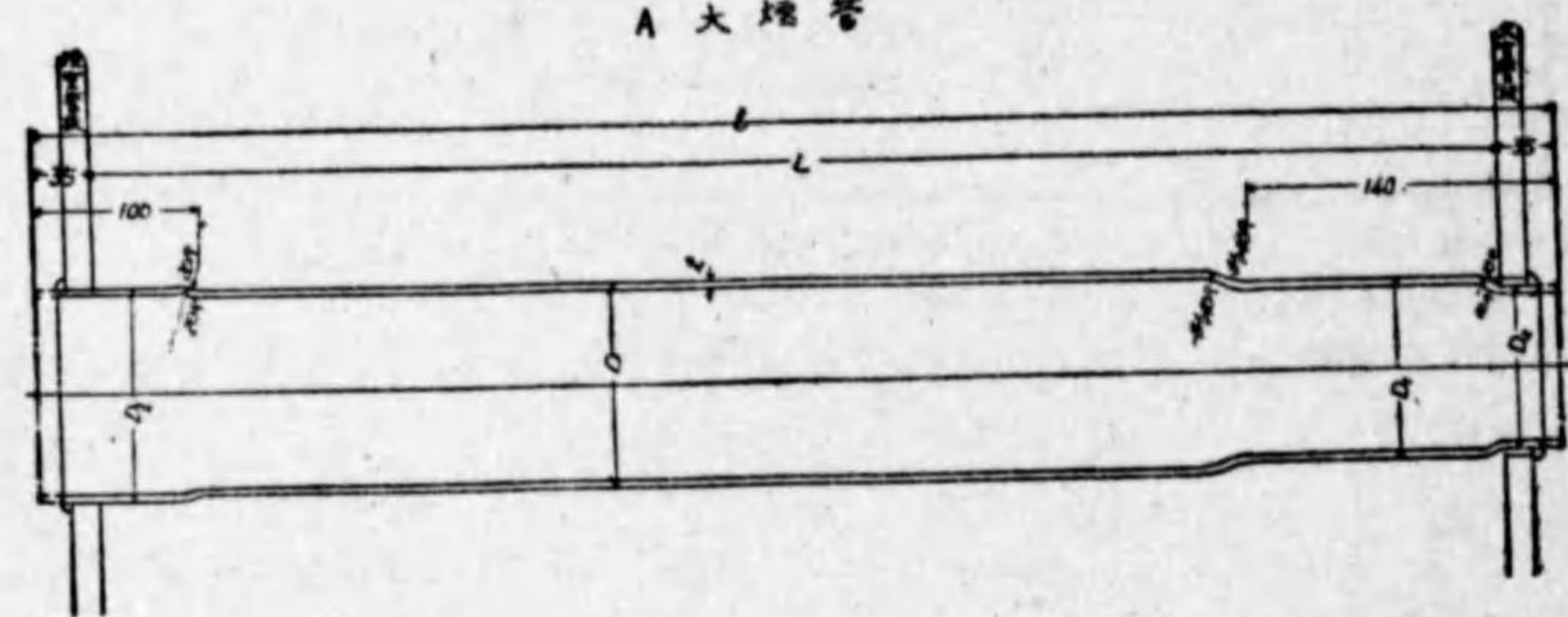
第 40 圖 煙管の基本寸法
