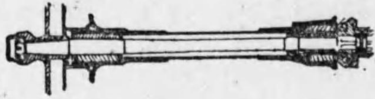
第21圖 半浮動式後車軸
