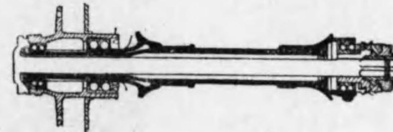
第19圖 全浮動式後車軸
