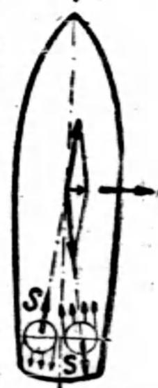
翼片擺動度之大小，即由此而決定此機之漩進率者，可隨時校正改變之，即船身係以最大速率向前進，亦可使之以最大速率向後退，只須將指向點 N 在「橫向」直徑，即與船長成垂
