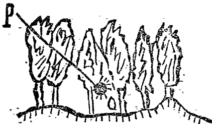
P O 爲彈道 O 爲炸點 P 爲碰擊點 (着發溜彈，對掩蔽部之効力)
